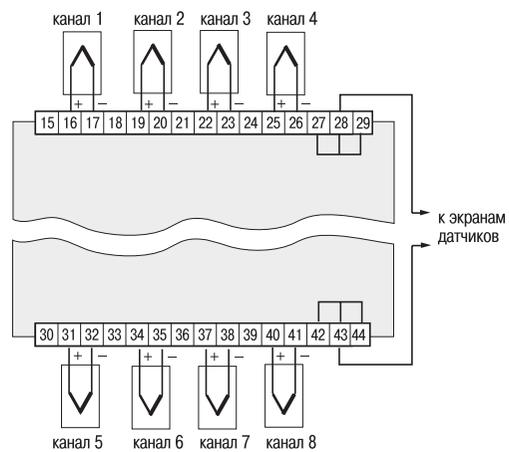
Рис. Б.3. Подключение термоэлектрических преобразователей к приборам модификации УКТ38-Щ4.ТП и УКТ38-Щ4.ТПП
