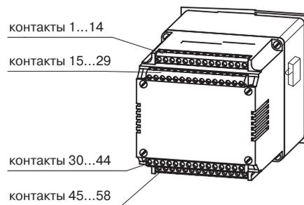
**Рис. Б.1. Расположение клеммников на корпусе прибора**
