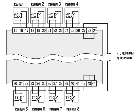
**Рис. Б.2. Подключение термопреобразователей сопротивления к прибору модификации УКТ38-Щ4.ТС**
