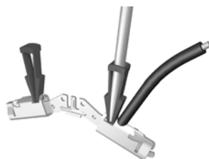
Принцип работы технологии с прорезанием изоляции
