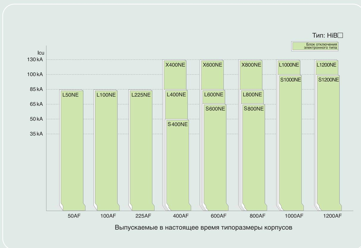
Примечание. Icu: Отключающая способность при 415 В переменного тока в соответствии с IEC60947-2
