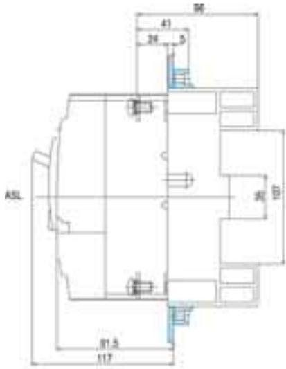
4 монтажных отверстия Ø 6
