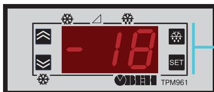
Кнопка в режиме ТЕРМОСТАТ: кратковременное нажатие — редактирование значения SP, длительное нажатие (> 5 с) — вход в режим ПРОГРАММИРОВАНИЕ, в котором используется для вывода значения выбранного параметра или для записи измененного значения в память.
