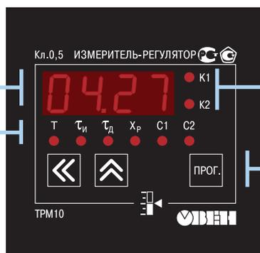
**Светодиоды «К1» и «К2»** сигнализируют о включении выходных устройств: «К1» — ВУ ПИД-регулятора; «К2» — реле двухпозиционного регулятора.
